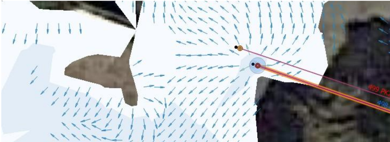
Beispielhafte Darstellung eines Kanalüberstaus auf das Oberflächenmodell
